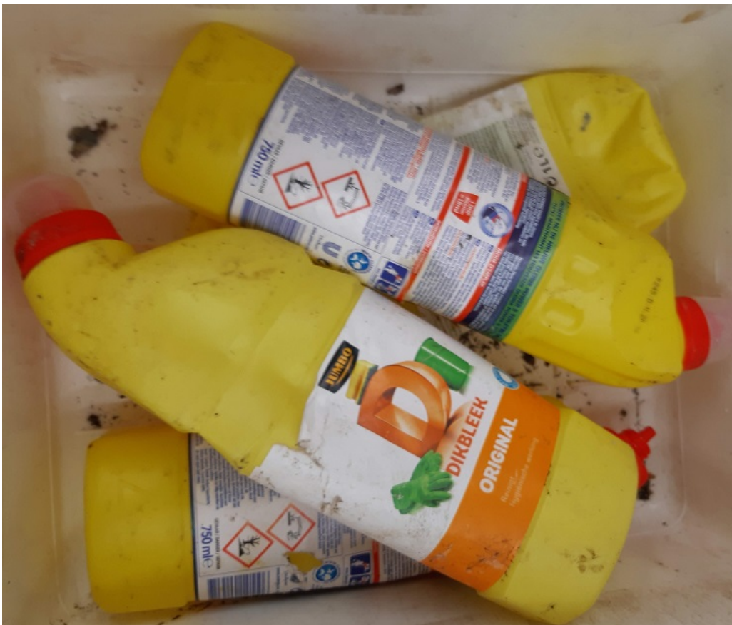
Foto A6.8 Beperkt recyclebare PE flacons met papieren labels die niet volledig aan de flacon zijn vastgekleefd.
