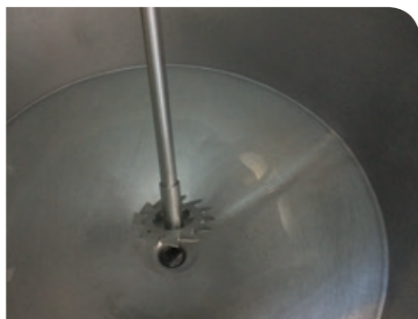
De ketel is gereinigd en lijkt schoon (l). Na een biofilmaudit (midden) wordt biofilm aangetoond.
