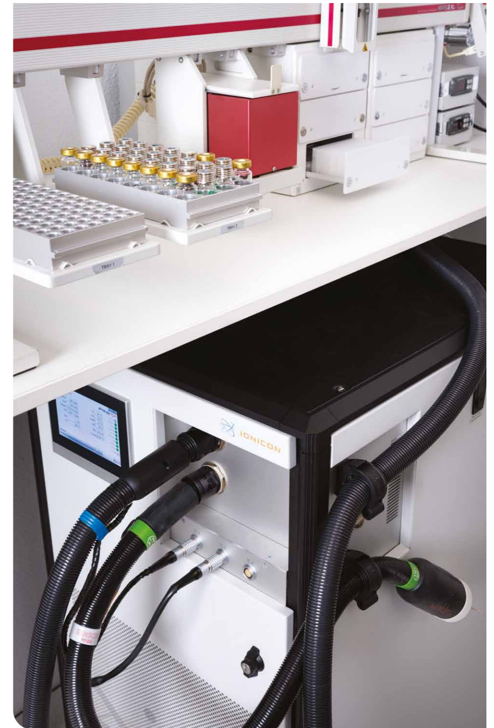
Hoge resolutie massaspectrometer, gebruikt voor meting van aromacomponenten in de uitgedemde lucht en voor screening van flavourcomponenten gegenereerd door fermentatie ('Miniscreen')
